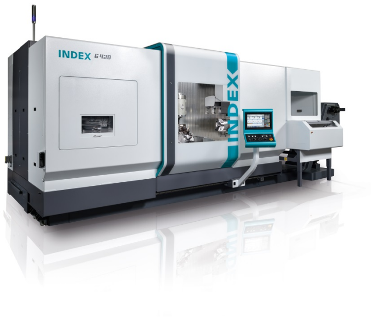
Bild 2: Optional kann zudem eine 2-Achs-Handhabungseinheit für das Be- und Entladen sowie Reststückentnahme bis zu einem Teilegewicht von 20 kg integriert werden, so dass die G420 alles für den mannarmen (zum Teil gar mannlosen) Betrieb mitbringt.
