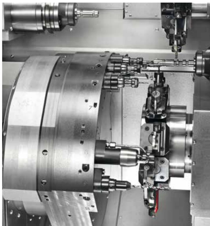
La caractéristique phare de la machine TRAUB TNL32-11 est l'appareil frontal équipé de 8 postes d'outils dont 4 entraînés.
