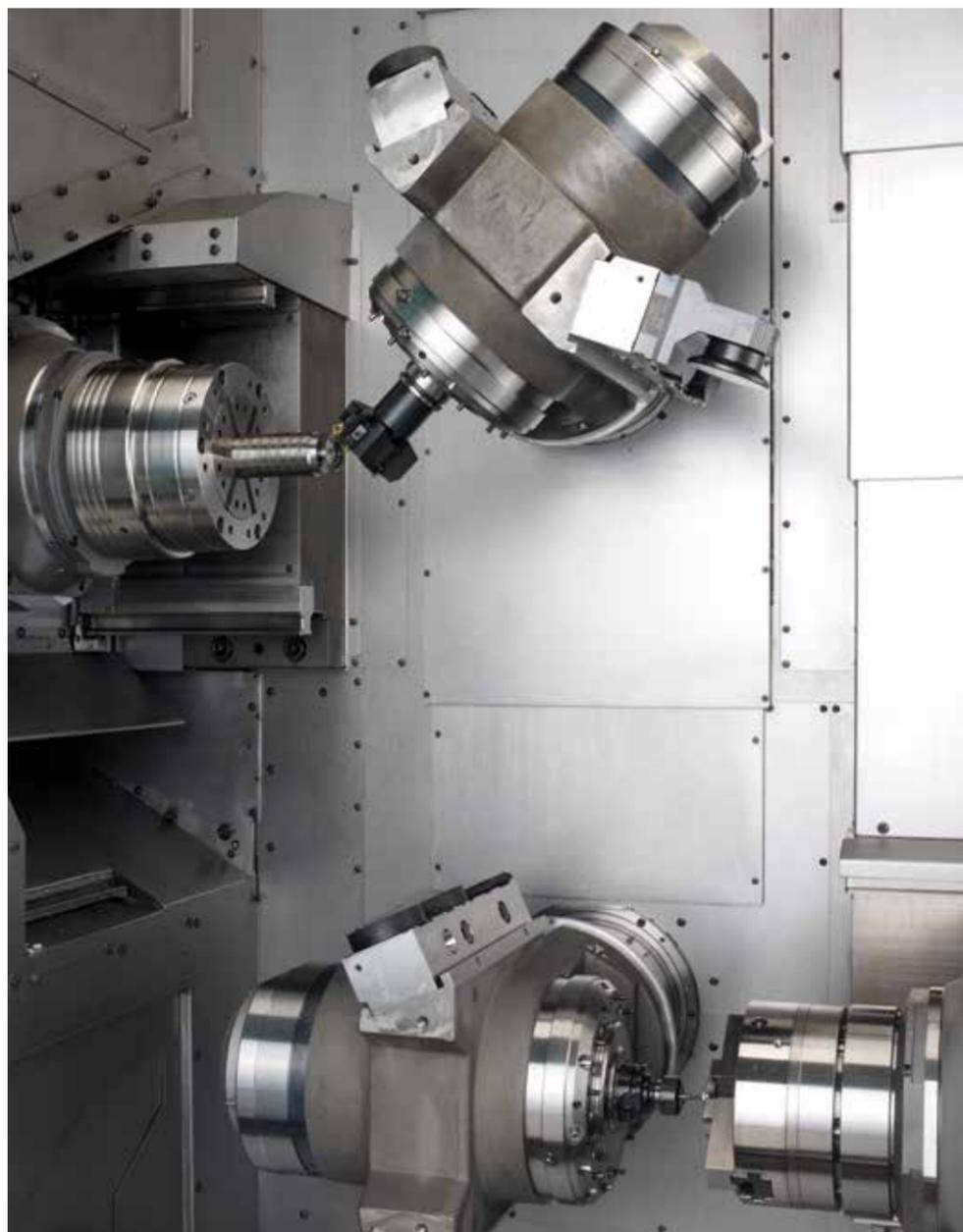
Les centres de tournage/fraisage INDEX R200 et R300 possèdent une broche principale et une contrebroche. L'espace d'usinage contient deux porte-outils dotés respectivement d'une motobroche de fraisage. Grâce à la configuration d'axe, il est possible d'usiner avec cinq axes sur les deux broches.
