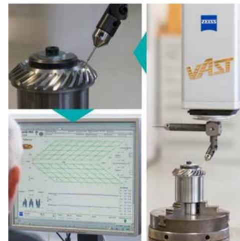
La fonction GearEngineer permet de calculer toutes les données de mesure de consigne de la topologie de flancs. Elles sont chargées sur une mesure de mesure de coordonnées 3D pour une comparaison Consigne/Réel. Les écarts mesurés peuvent être insérés dans le cycle de commande INDEX, qui calcule de manière automatique les données de correction pour les données de réglage de la machine.
