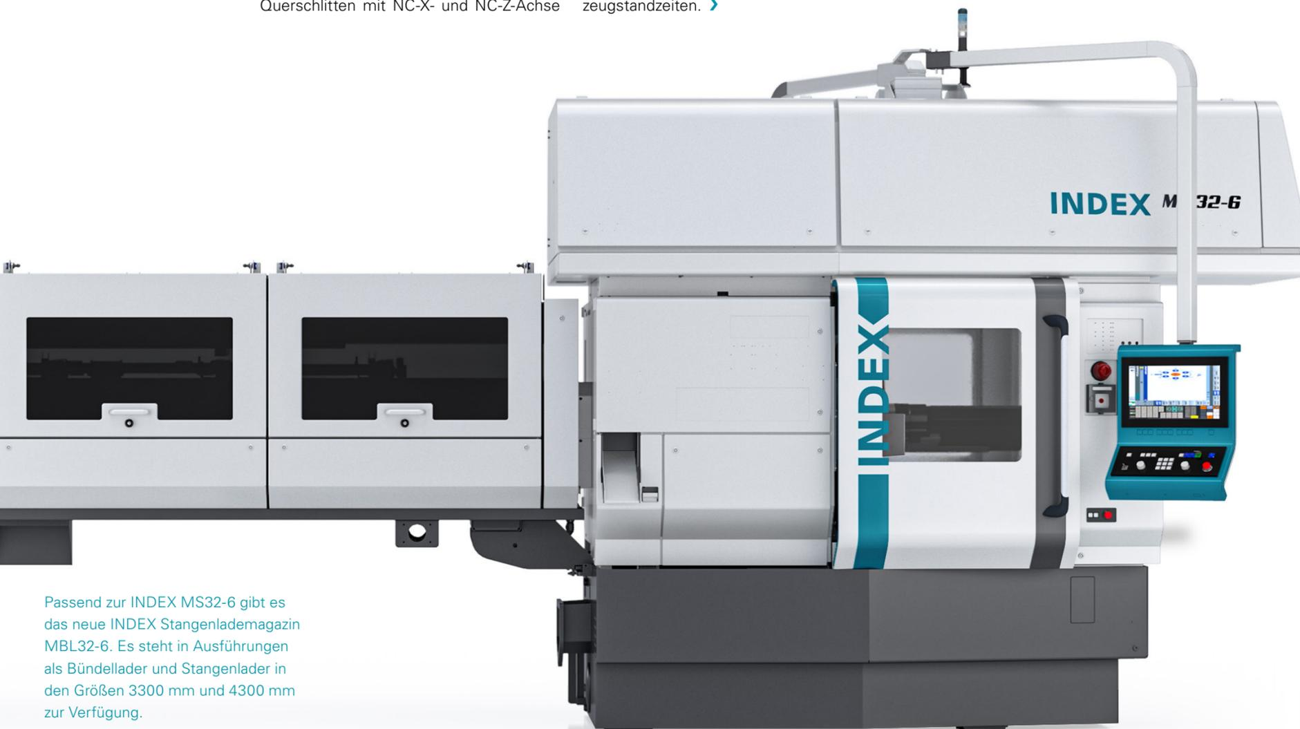
Passend zur INDEX MS32-6 gibt es das neue INDEX Stangenlademagazin MBL32-6. Es steht in Ausführungen als Bündellader und Stangenlader in den Größen 3300 mm und 4300 mm zur Verfügung.
