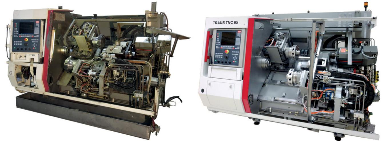
So sah die fast zwölf Jahre alte TRAUB TNC65 vor dem Refit aus. Nach dem Refit sieht die Maschine nicht nur aus wie neu, sie ist auch mindestens so genau wie bei der Erstausslieferung.
